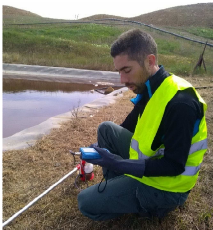
Figure 4 : Prise de mesures physico-chimiques sur l'échantillon du bassin lixiviats.
